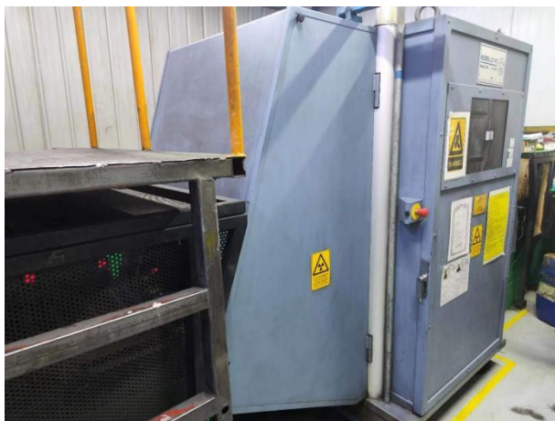
图 7-1 本项目 X 射线实时成像检测系统外型图
