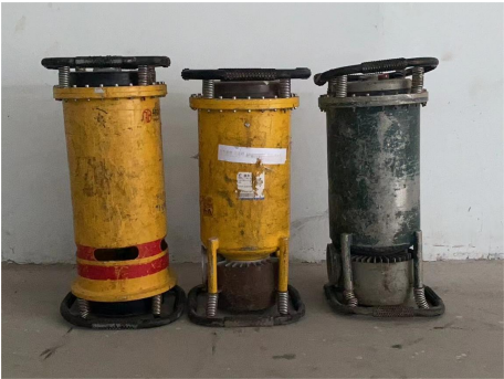
图 2-7 本项目 X 射线探伤机
