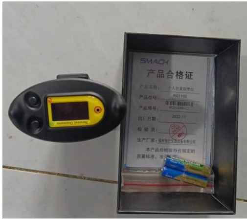
RG1100型个人剂量报警仪
