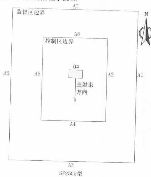
附图 1: 模拟探伤现场检测点位示意图
