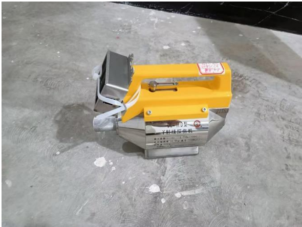
图 2-5 (a) ^{192}\text{Ir} \gamma 射线探伤机外形图
