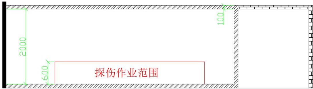
图 7-5 (b) X 射线探伤机在探伤室内探伤作业范围示意图 (1-1 剖面，单位：mm)
