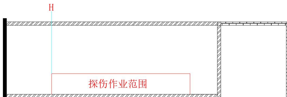
图9-1 (b) 探伤室1-1剖面预测点示意图
