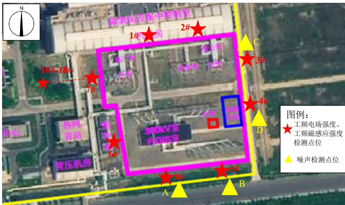
图 4.3-1 电磁环境监测布点示意图
