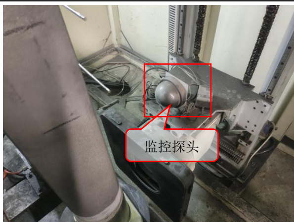
X 射线实时成像检测系统内 载物台北侧监控探头
