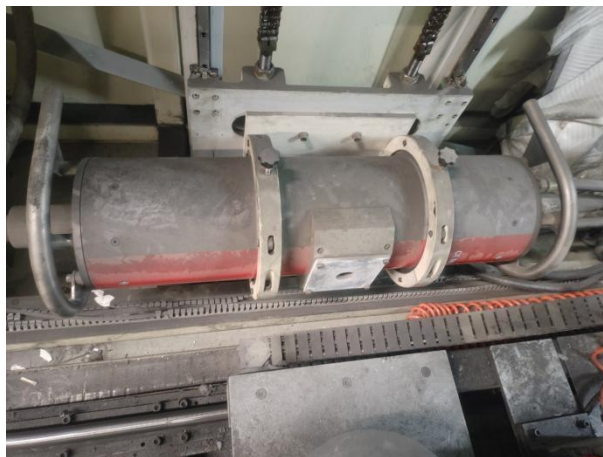
图 2-3 本项目所涉及 X 射线机外观
