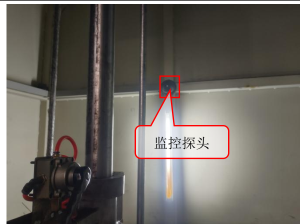
X 射线实时成像检测系统内 东防护面中间监控探头
