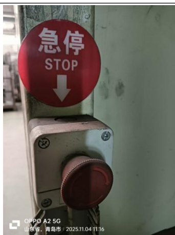
X 射线实时成像检测系统内 门洞北侧自带急停按钮
