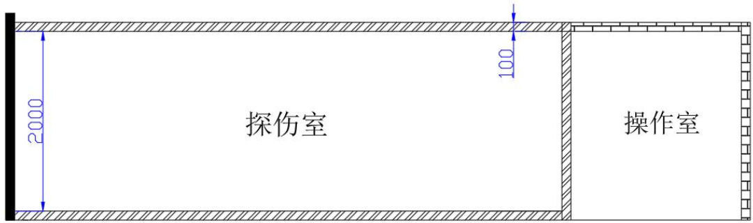
图 2-1 (b) 本项目探伤室 1-1 剖面布置图 (mm)
