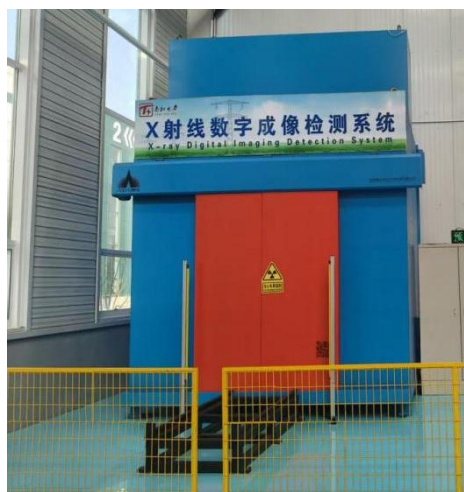
图 2-5 本项目 X 射线实时成像检测系统设备外观
