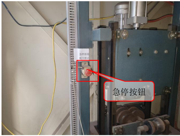
X 射线实时成像检测系统内 自带急停按钮
