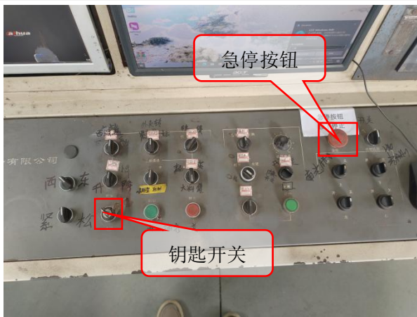
X 射线实时成像检测系统内 自带急停按钮
