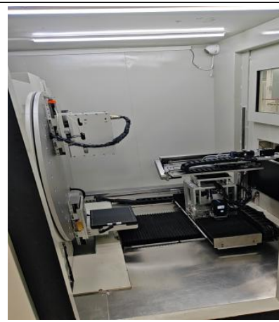
5#工业CT机辐射屏蔽室内部 (L2161型)
