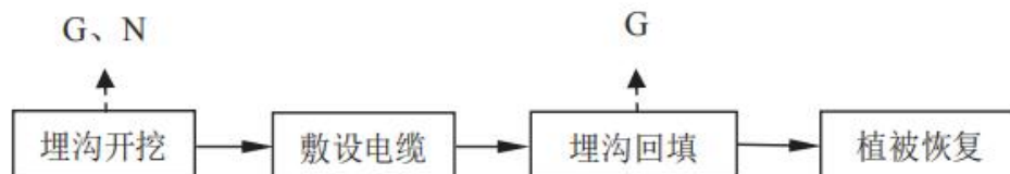
图 4-3 集电线路施工工艺流程图
