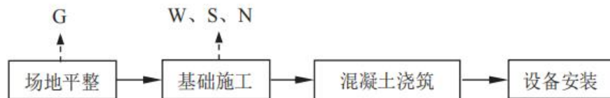
图 4-2 逆变器及箱变施工工艺流程图
