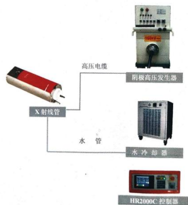
图 2-5 (b) HS-XYD-225 型 X 射线实时成像检测系统组成结构
