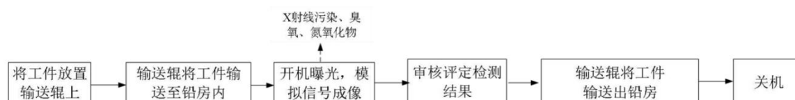
图2-5 X射线实时成像检测系统（DR）工作流程及产污环节示意图
